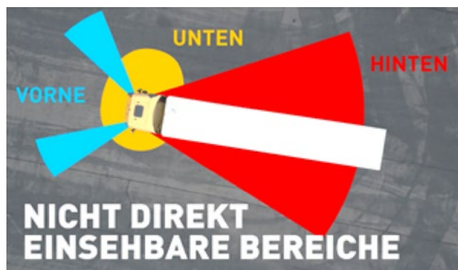
Es gibt mehrere „Tote Winkel“ bzw. nicht direkt einsehbare Bereiche an einem Lkw 3
